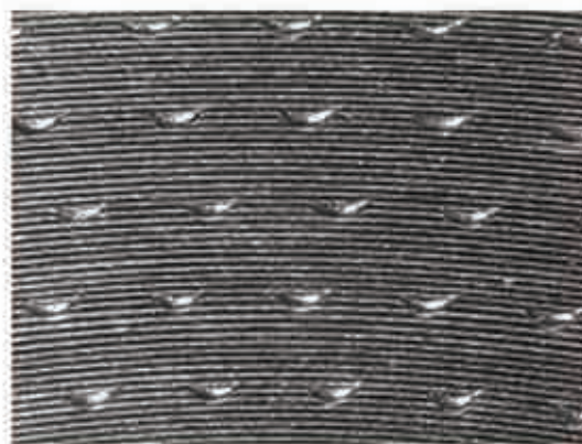
Рис. 4. Поверхность с нанесенным частично регулярным микрорельефом
