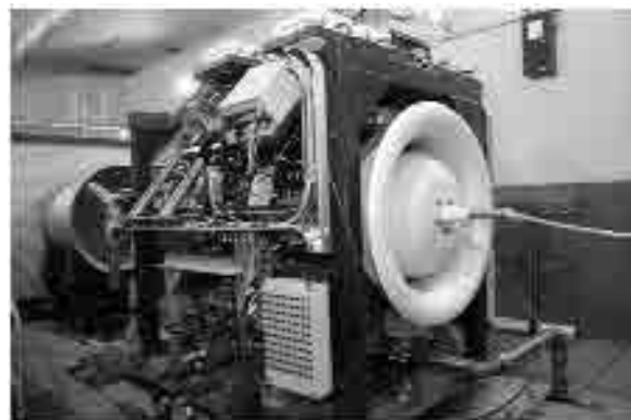
Рис. 1. Рама-адаптер с газогенератором ПД-14 на стенде
