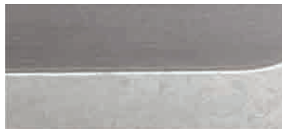
Рис. 4. Карман травленной обшивки после лазерного раскроя
