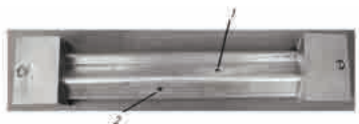
Рис. 4. Образец профиля в захватах для испытаний на МЦУ:
