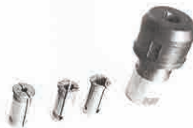
Рис. 5. Сверлильный патрон со сменными цилиндрическими цангами
