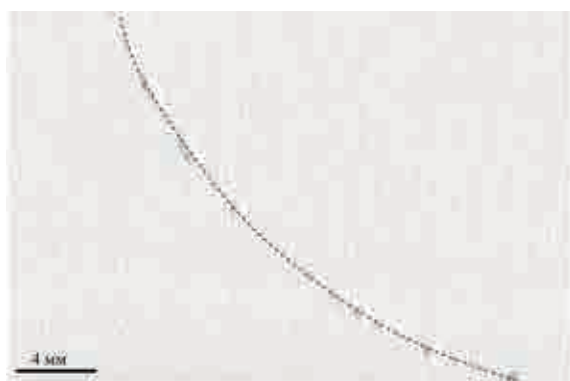
Рис. 3. Образованные лунки по контуру раскроя после РХТ
