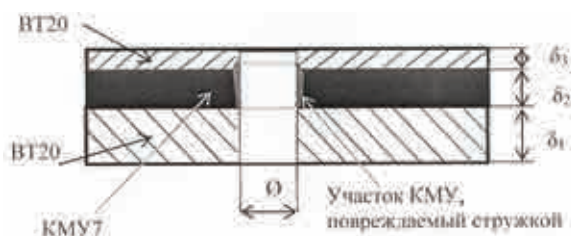
Рис. 1. Типовой характер повреждения отверстия в ПКМ стружкой в разнородном пакете ( \delta – соответственно толщины элементов пакета)
