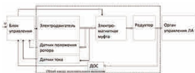
Рис. 1. Функциональная схема привода
