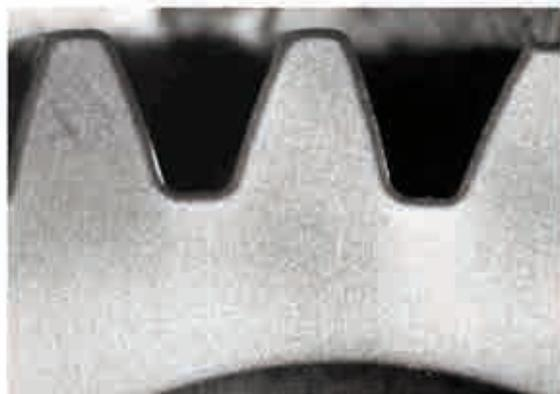
Рис. 2. Распределение азотированного слоя по профилю мелкозубчатого конического зубчатого колеса из стали ВКС-5 [2]
