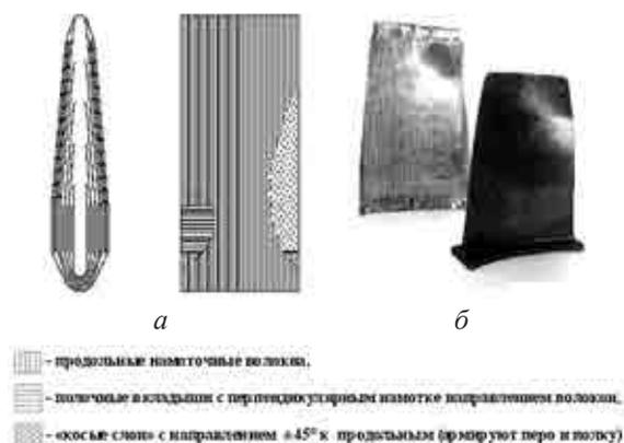
**Рис. 6.** Схема армирования пакет-заготовки (а), пакет-заготовка однолопаточной лопадки, изготовленной методом намотки, и готовая лопадка (б)
