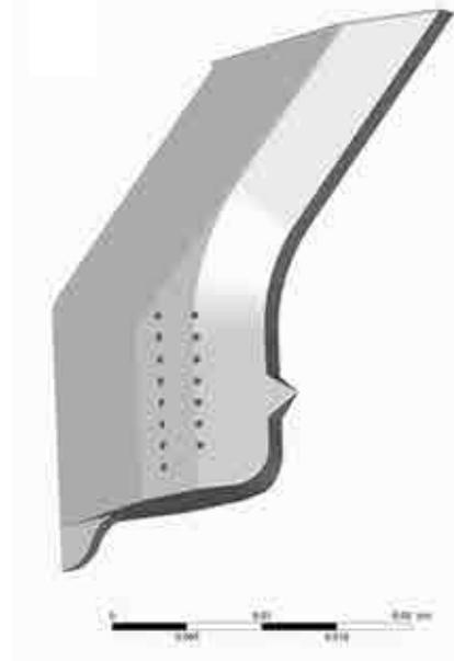
Рис. 1. Конструкция анода модуля
