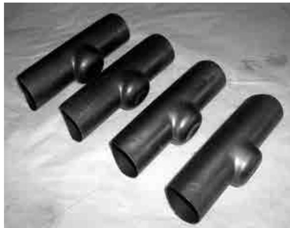
Рис. 4. Партия деталей после операции формовки отвода
