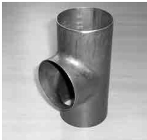
Рис. 5. Готовый тройник после отбортовки отверстия в дне отвода
