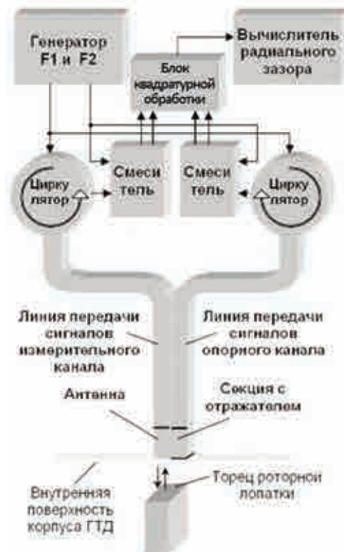
Рис. 1. Структурная схема МСИРЗ с улучшенными характеристиками
