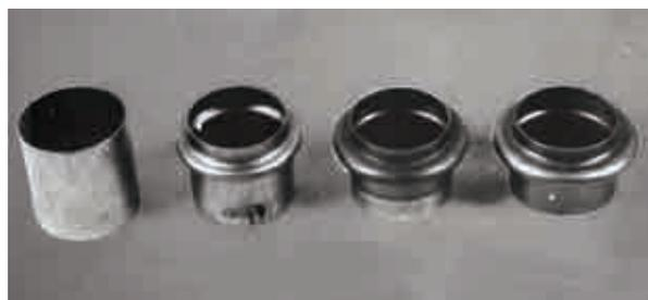
Рис. 7. Трубная заготовка и фланцы диаметром условного прохода 63 мм из сплава ПТ-7М с предварительным гофром, полученным за один переход операции формообразования с различными степенями окружной деформации: 12; 18 и 28 % соответственно, без появления браковочных признаков
