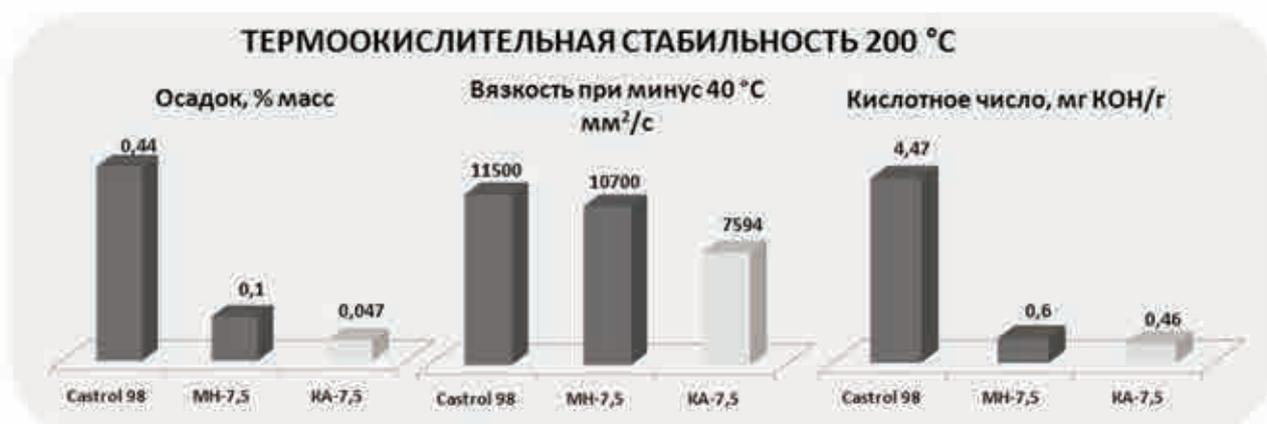
Рис. 2. Эксплуатационные свойства масла КА-7,5 в сравнении с отечественными и зарубежными аналогами
