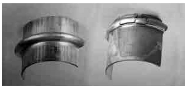
**Рис. 3. Полуфабрикаты облегченных фланцев после 1-го перехода операции формообразования с характерными макротрещинами на поверхности зига,  $\times 100$ :**
