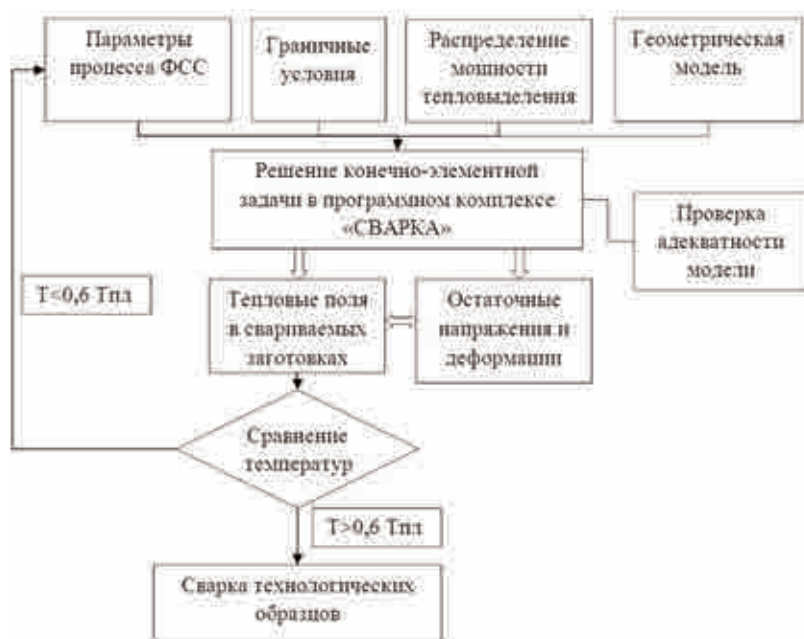
Рис. 2. Блок-схема расчета тепловых полей и деформаций при КФС
