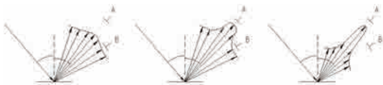
Рис. 3. Рассеяние падающего луча света на поверхностях с разной шероховатостью [8]
