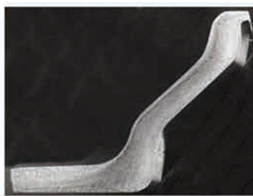
Рис. 6. Металлография детали, полученной вытяжкой. Степень предварительной деформации 32 %,  $T = 320\text{ }^{\circ}\text{C}$
