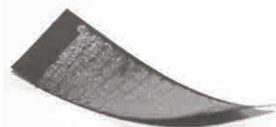
**Рис. 6. Вид образца после электроискрового легирования электродом из ВК6М**
