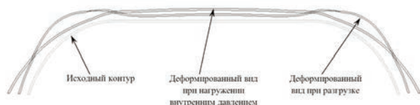
Рис. 1. Деформированное состояние лейнера при максимальном давлении и полной разгрузке
