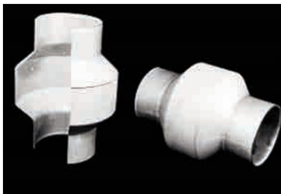
Рис. 2. Образцы тонкостенных переходников. Труба Ø 50×1,5 мм; сплав АМг6 (D/d = 1,6; S/d = 3 %)
