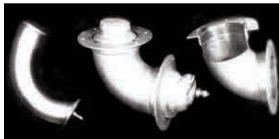
Рис. 6. Образцы крутоизогнутых патрубков с фланцами ( R\rho/D = 1 )
