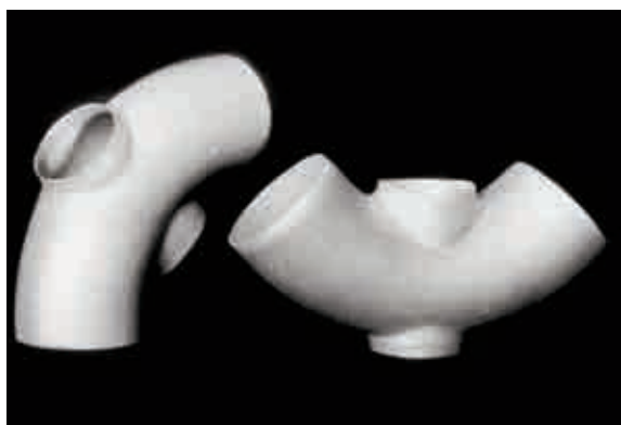
Рис. 5. Образцы патрубков с отводами. Труба \varnothing 50 \times 1,5 мм; сплав АМг6
