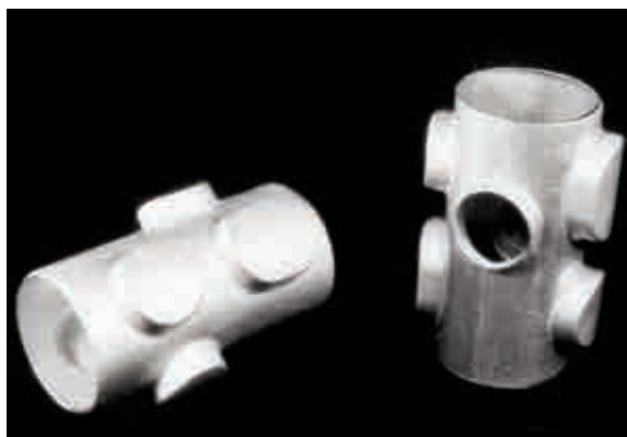
Рис. 4. Образцы трубных коллекторов. Труба \varnothing 30 \times 1,0 мм; сплав ОТ4
