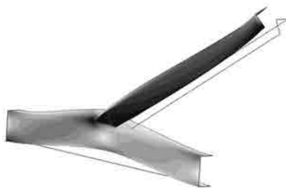
Рис. 1. Соединение швеллер–уголок. Нагрузка приложена вертикально вверх (разрушающая нагрузка на соединение 120 кН)
