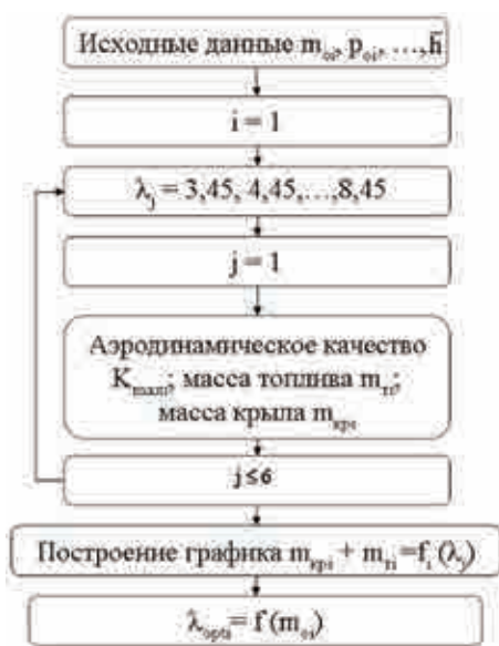
Рис. 2. Алгоритм нахождения оптимального удлинения: m_{oi} = \text{const} , p_{oi} = \text{const} , i = 1, 2, 3
