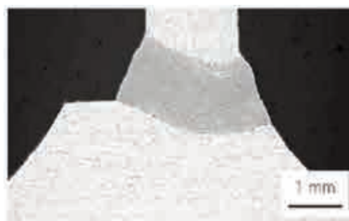
Рис. 9. Поперечное сечение лазерного сварного соединения «монтажный зажим-обшивка»
