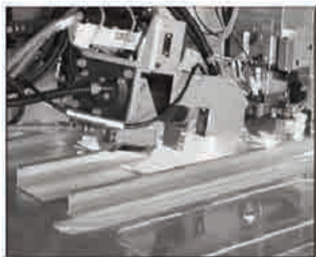
Рис. 7. Опытная установка для автоматизированной сварки монтажных зажимов
