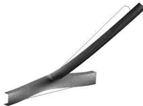
Рис. 2. Соединение швеллер–уголок. Нагрузка приложена вдоль уголка в центре тяжести сечения (разрушающая нагрузка на соединение 149 кН)
