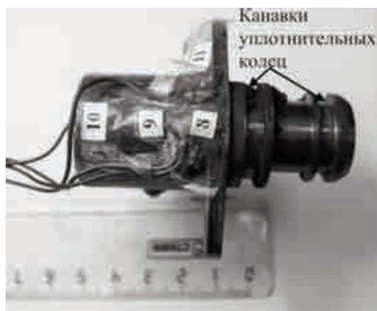
Рис. 5. Сигнализатор и имитатор после огневых испытаний
