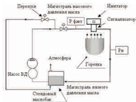
Рис. 3. Принципиальная схема стенда Г17-ЦЗ
