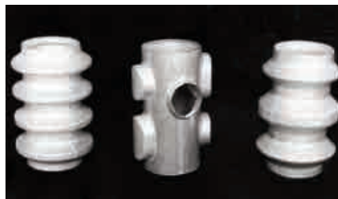
Рис. 2. Трубные детали, изготовленные пневмотермической формовкой Сплав ОТ4, тр. 50×1,0 мм
